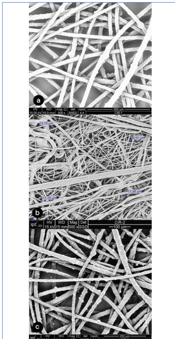
**[Table/Fig-3]:** (500 X) Photomicrographs of surgical mask layers. a) layer 1; b) layer 2; c) layer 3.
